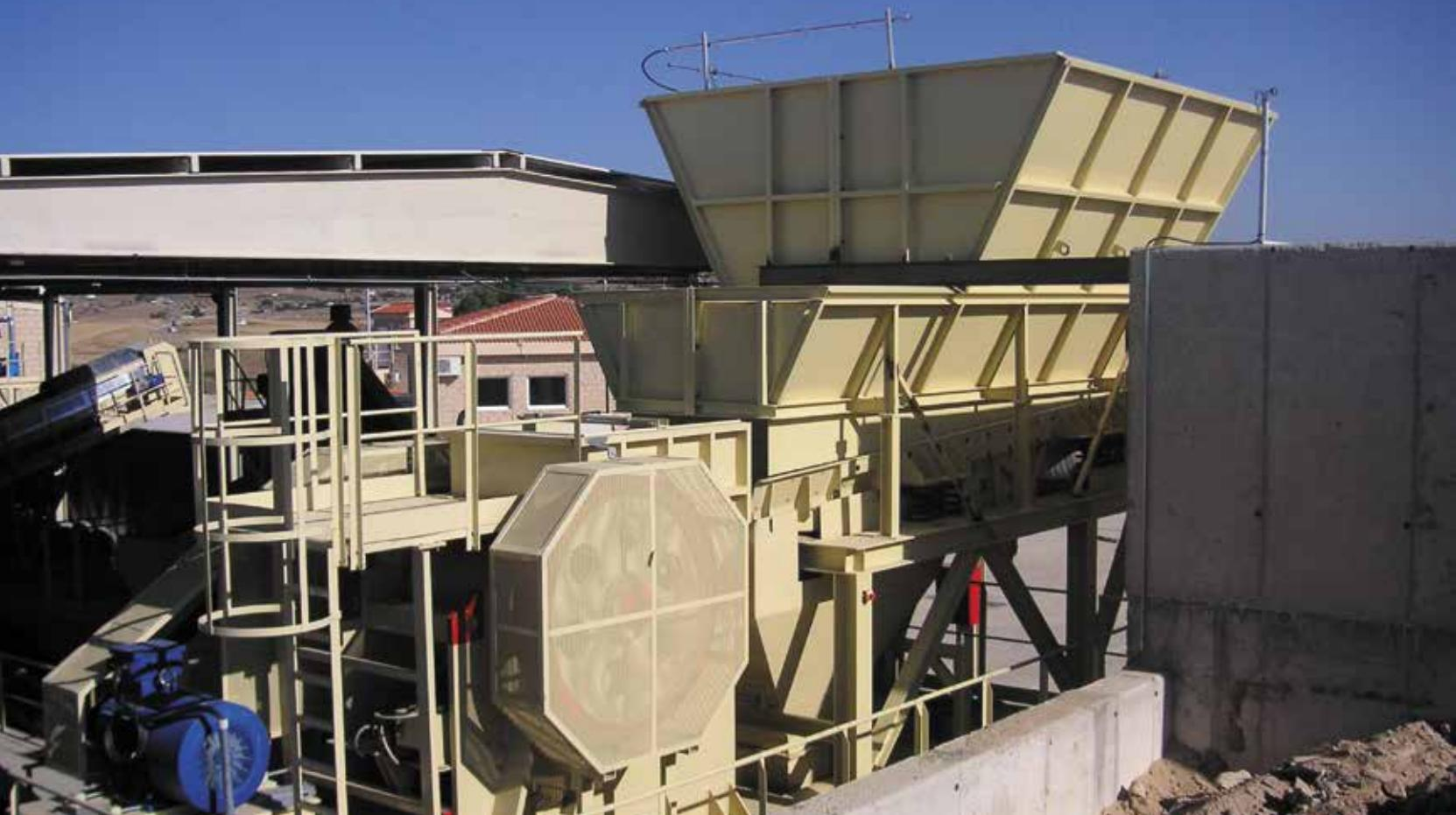
Instalaciones para el tratamiento de los residuos generados en los trabajos de obra civil: derribos de edificios, obras menores, etc. Las instalaciones se diseñan y suministran en función de las distintas características y composiciones que pueda tener este tipo de residuo, así como los diferentes usos a los que se destinan los materiales reciclados.
